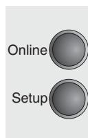
Dès que l'imprimante est mise sous tension, elle passe automatiquement en mode Online. Elle ne peut recevoir des données de l'ordinateur que dans ce mode.
