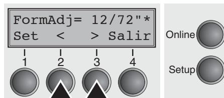
Por medio del pulsador < (2) o > (3) ajuste la primera línea de impresión a la posición deseada. Se pueden ajustar valores entre 0 y 220/72" para papel continuo y para hojas sueltas.
