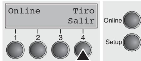
Después de cortar el papel presione el pulsador **Salir** (4). La impresora reposiciona el papel a la primera posición de impresión.
